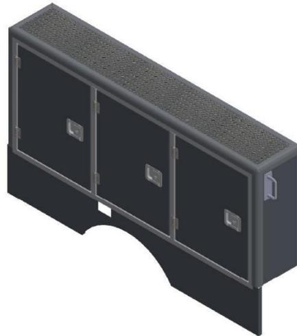
Todos os armários e caixas serão confeccionados em chapas de duralumínio na liga ASTM-5052 H-34 com espessura de 2,0mm no formato de bandeja proporcionando ótima rigidez. Reforço nas tampas através de forros confeccionados em chapas de alumínio liga ASTM-5052 H-34 com espessura de 1,5mm colados às portas com massa terostática. Prateleiras fixas em chapas de alumínio na liga ASTM-5052 H-34 com espessura de 2,0mm revestidas com mantas de borracha.
